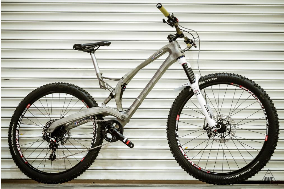
Gövdesi 3D yazıcıyla, titanyumdan üretilen ilk bisiklet (2014-İngiltere)
