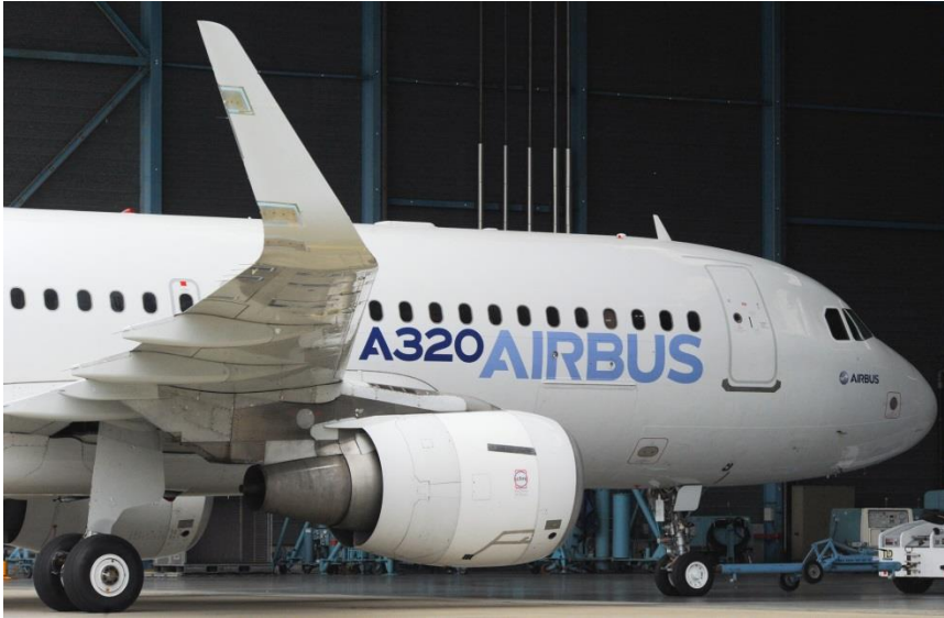
Airbus A320 uçağının köpekbalığı yüzgeci formundaki kıvrık kanat ucu
