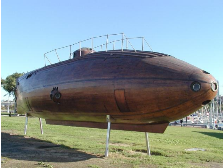
Hidrojen peroksit ve potasyum permanganat ile çalışan İspanyol denizaltısının replikası (Barcelona-1867)
