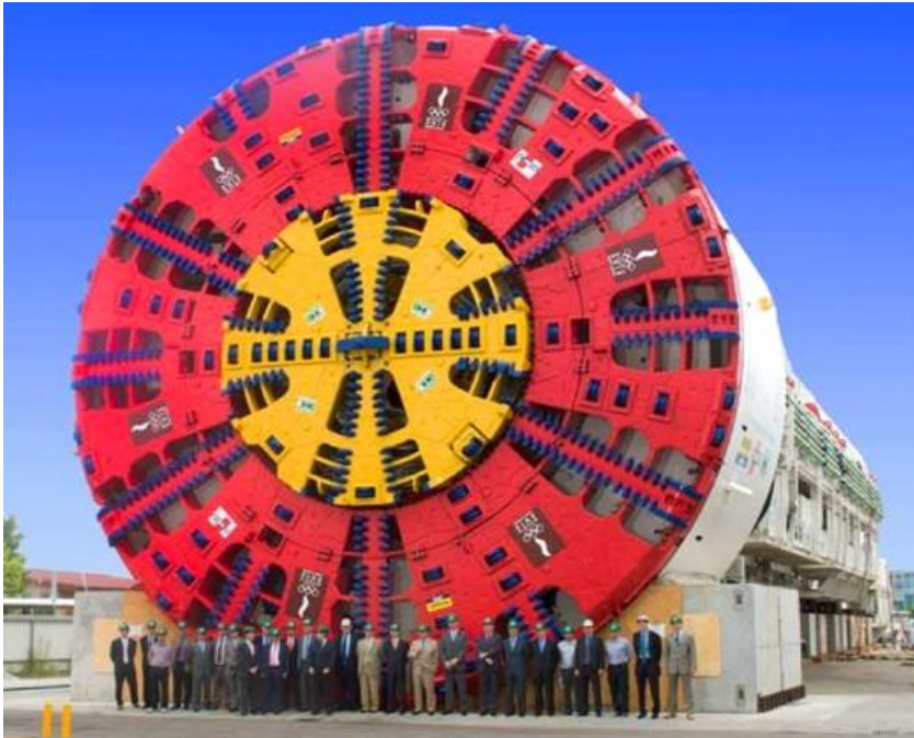
Modern bir tünel kazma makinesi ve teknisyenler
