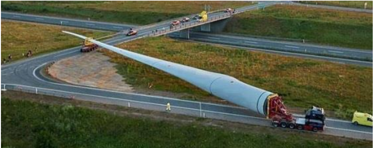
Karbon fiber-epoksi reçinesinden Danimarka'da yapılan 83,5 metrelik dünyanın en uzun rüzgar türbini pervanesi
